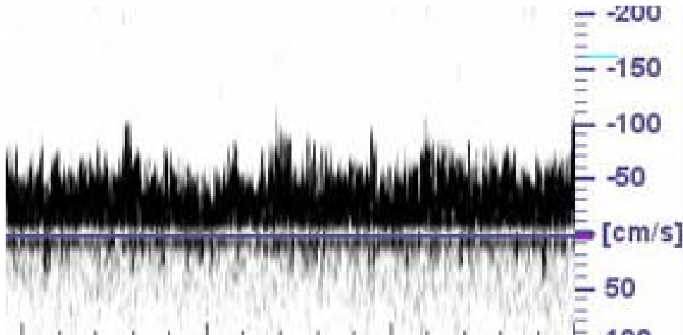
Gambar 10. 3 Fluktuasi kecepatan aliran turbulen
