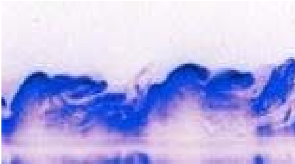
Gambar 10. 4 Karakteristik Eddy dalam turbulensi
