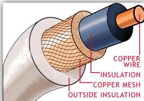
Kabel ini sering digunakan untuk antena televisi dan transmisi telepon jarak jauh. Konektornya adalah **BNC** (British Naval Connector). Kabel ini terbagi menjadi 2, yaitu:
