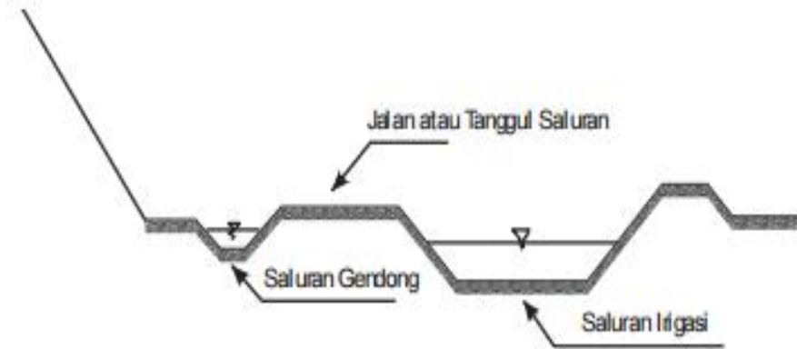
Gambar 3-9. Potongan Melintang Saluran Gendong dan Saluran Irigasi
