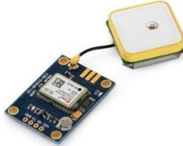
Gambar 4. 4 Sensor GPS
