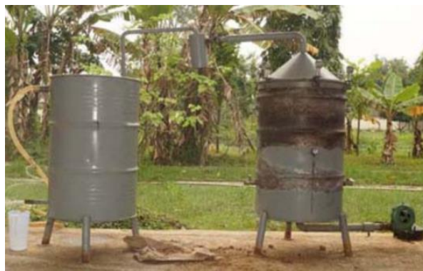
Gambar 6.7 Alat destilasi asap cair
