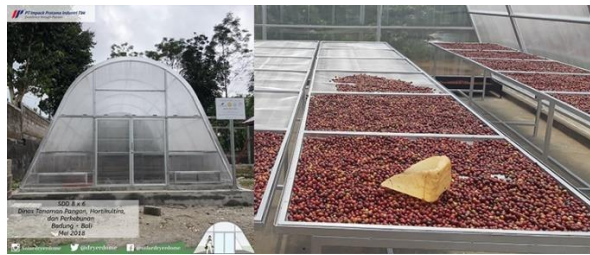
Gambar 6.1 Alat pengering tenaga surya
