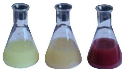
Gambar. Proses pembentukan endapan selama proses titrasi dengan Metode Volhard
