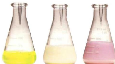
Gambar. Proses pembentukan endapan selama proses titrasi dengan Metode Fajans
