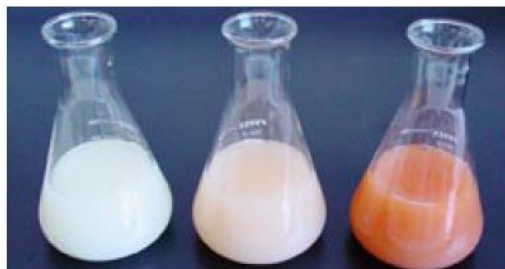
Gambar. Proses pembentukan endapan selama proses titration dengan Metode Mohr
