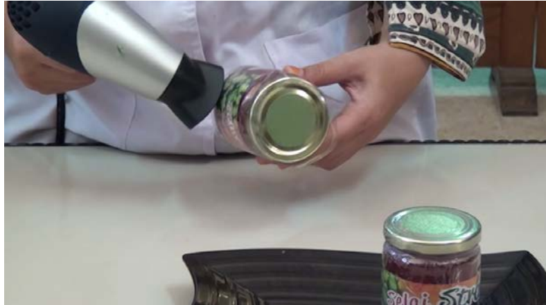
Gambar 29. Pemasangan Plastik Sringe
