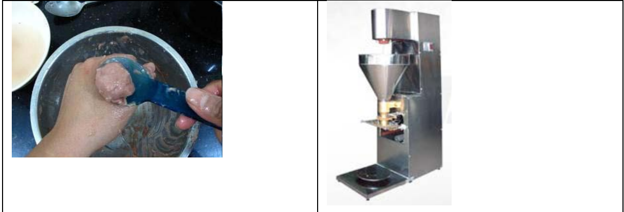
Gambar 7. Pencetakan Bakso dengan Tangan dan Sendok (kiri) dan dengan Mesin Cetak Bakso (kanan)
