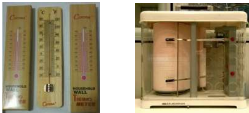
Gambar 6.5. Alat pengukur suhu udara : (i) Termometer (ii) Termograf
