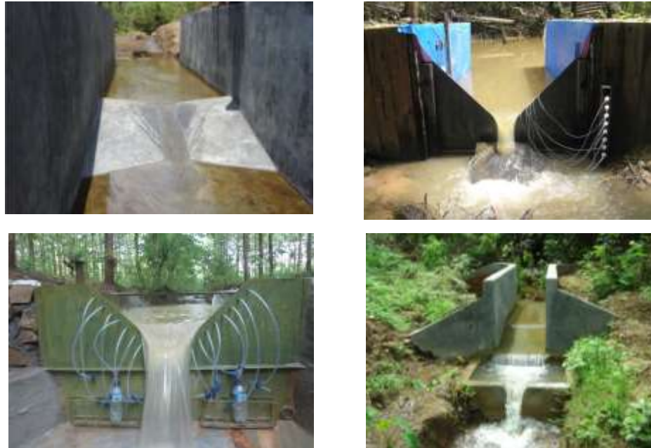
Gambar 6.10. Saluran Pengamatan Aliran Sungai (SPAS)
