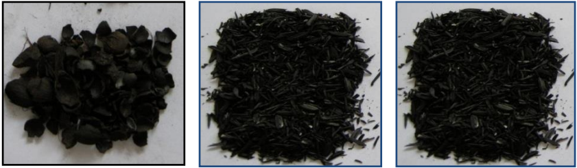
Gambar 1-7. Biochar dari berbagai bahan yang berbeda: kelapa sawit (kiri), jerami padi (tengah) dan kakao (kanan).
