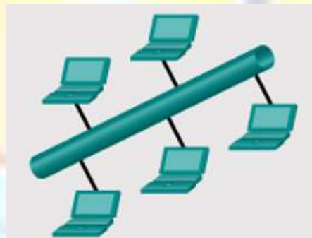
Gambar 4.31 Topologi fisik Bus
